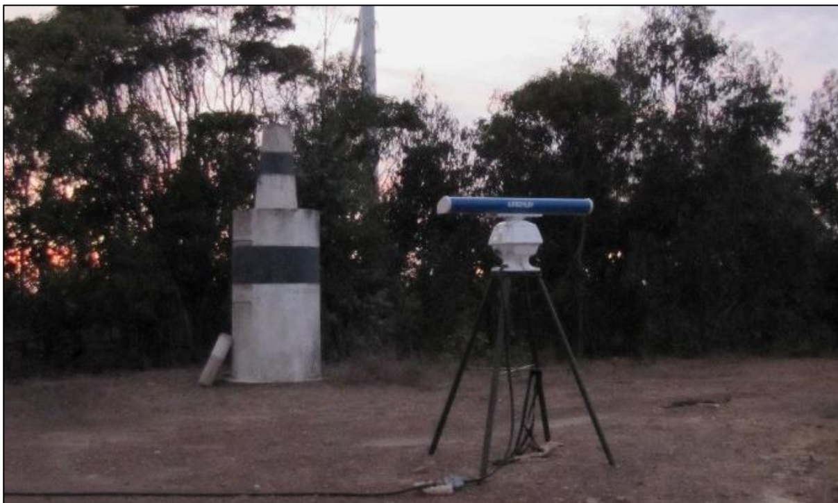
Figura 9 – Equipamento radar utilizado na monitorização de aves planadoras migradoras (foto: Ricardo Tomé).
